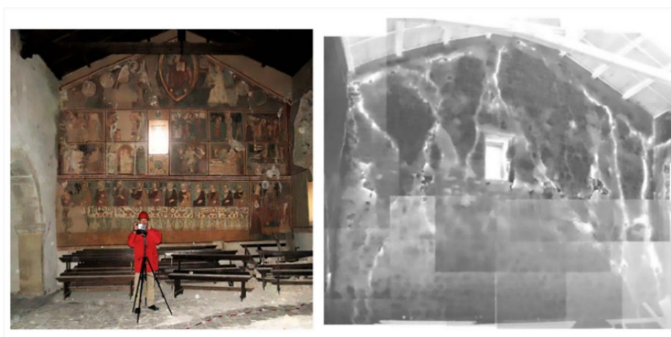
شکل ۸. نقاشی دیواری در معرض خطر زلزله: تشخیص لایه‌لایه شدن و ترک‌های ساختاری توسط ترموگرام منبع (Grinzato, 2012)
