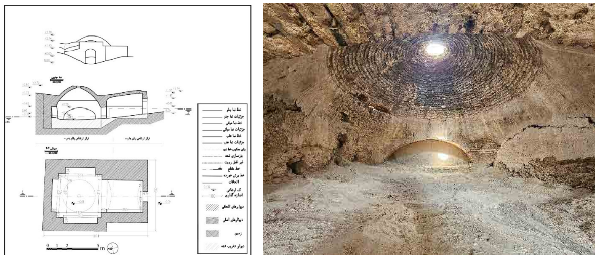
تصویر ۹: فضای داخلی سازه چلیپا (سمت راست)، پلان، مقطع و نمای اتاق چلیپا (چپ) (نگارندگان، ۱۴۰۳).
