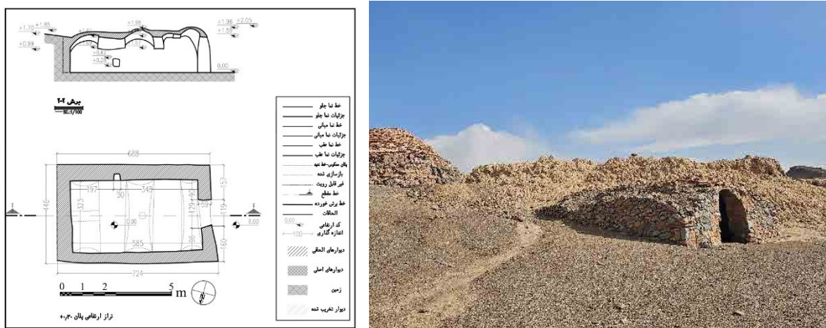
تصویر ۱۰: تک اتاق حوض‌خان، دید به جنوب شرق (راست)، پلان و مقطع تک اتاق (چپ) (نگارندگان، ۱۴۰۳).
